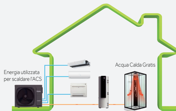
Con recupero di calore
